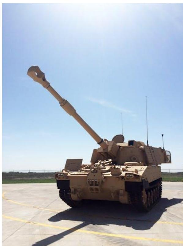
M109A7 — новейшая версия M109 для военной службы США. Ранее известная как версия M109A6 Paladin Integrated Management (PIM), M109A7 использует существующее основное вооружение и конструкцию кабины самоходной артиллерийской системы Paladin M109A6, а компоненты шасси машины заменяются современными компонентами, общими для боевой машины M2A3 Bradley.
