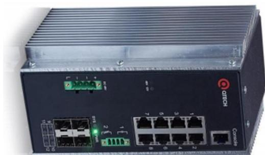
Рис. 6. Индустриальный Ethernet-коммутатор L3 серия QSW-3750
