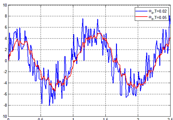
Рис. 3. Сравнение оценок производных сигнала при различных значениях T
