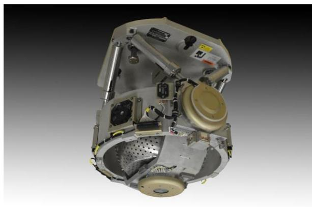
В новейшей морской навигационной системе ВМФ AN/WSN-12 используется новейшая технология волоконно-оптического гироскопа (FOG) для замены устаревшей технологии кольцевого лазерного гироскопа, где сигналы от навигационных спутников глобальной системы позиционирования (GPS) блокируются, глушатся или в противном случае отказано.
