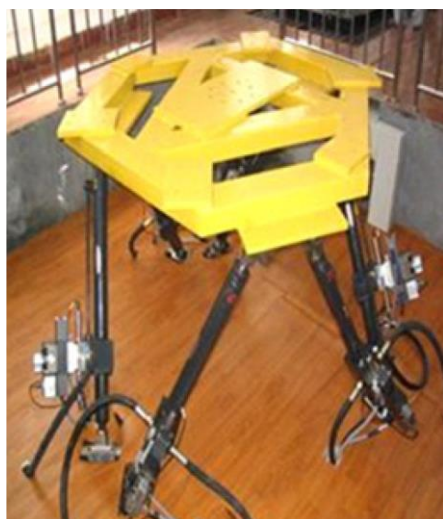
Рис. 1. Устойчивая модель стабилизированной платформы с использованием конструкции гидроцилиндра
