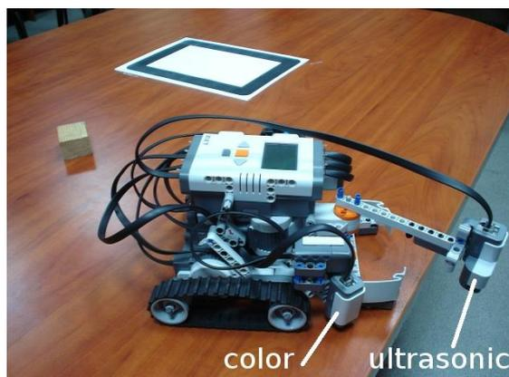
*Рис. 1.* Модель робота на основе конструктора *LEGO NXT* с ультразвуковым датчиком и датчиком цвета; блок «груз» (слева) и место складирования (вверху)
